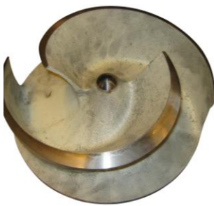
Impulsor semiabierto Aleación de cromo y molibdeno (42CrMo04) resistente a la corrosión y a la abrasión.
